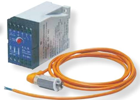
Dans le cas d'une défaillance de la membrane, le produit pompé pénètre dans la chambre d'air et déclenche le capteur. Le capteur envoie ensuite une impulsion électrique au dispositif de surveillance pour évaluation. L'unité de commande stoppe l'alimentation en air du distributeur d'air, entraînant alors l'arrêt du fonctionnement de la pompe.
