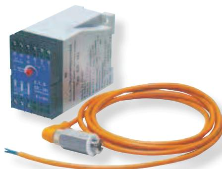
Dans le cas d'une défaillance de la membrane, le produit pompé pénètre dans la chambre d'air et déclenche le capteur. Le capteur envoie ensuite une impulsion électrique au dispositif de surveillance pour évaluation. L'unité de commande stoppe l'alimentation en air du distributeur d'air, entraînant alors l'arrêt du fonctionnement de la pompe.
