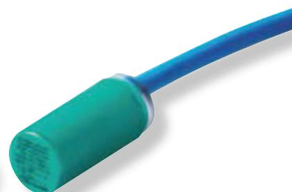
Le capteur du compteur de pulsations compte chaque cycle du mouvement de la membrane. Le débit de refoulement peut être déterminé en multipliant le nombre de cycles par les volumes de chambre de pompe. Le compteur de coups permet une mesure et un contrôle précis pour les applications de dosage.
